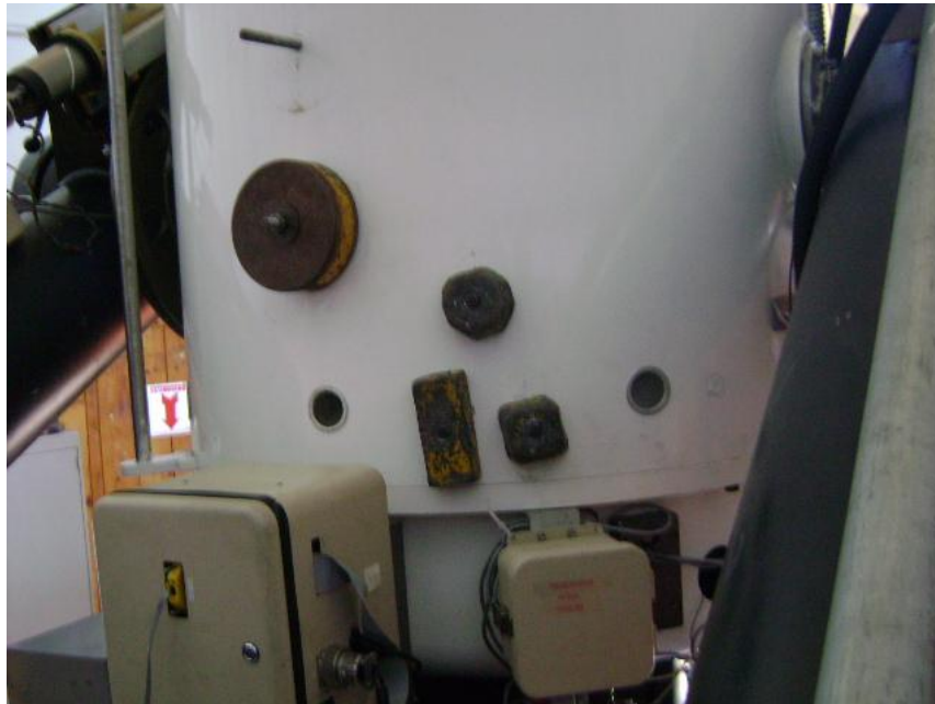
Figura 20. Contrapesos necesarios en la parte sur del telescopio de 84cm, para montar la cámara FLI y MEXMAN.
