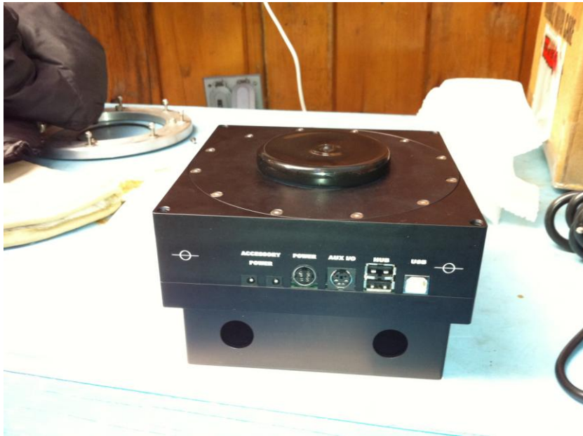
Figura 1.- La cámara FLI del OAN-SPM. Los conectores eléctricos se muestran al frente y los conectores del sistema de enfriamiento por líquido se encuentran en la parte posterior.
