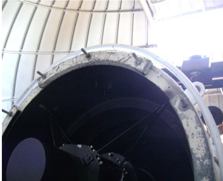
Figura 18. Contrapesos necesarios en la parte superior del tubo del telescopio de 84cm, para montar la cámara FLI y MEXMAN. Note los contrapesos largos en el Norte, Este y Oeste.
