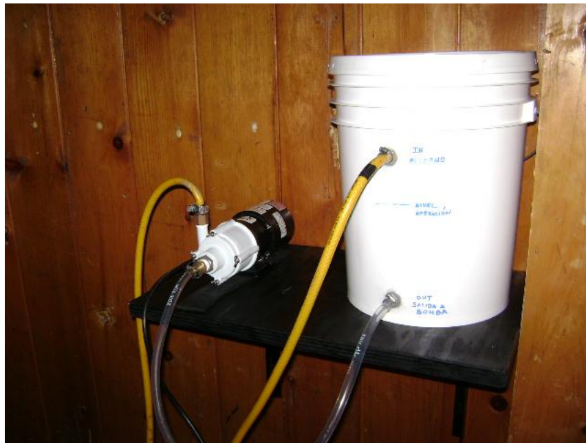
Figura 11. Cubeta y bomba circuladora para el enfriamiento por líquido de la cámara FLI en el telescopio de 84cm del OAN-SPM.
