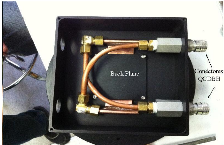
Figura B2.- Sección del ProLine Liquid Cooler una vez que se remueve las tapa inferior del cámara FLI.
