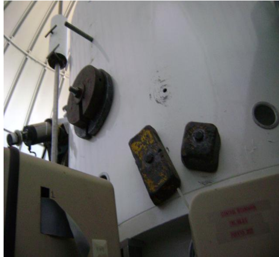
Figura 15. Contrapesos necesarios en la parte sur del telescopio de 84cm, para montar la cámara FLI y POLIMA.
