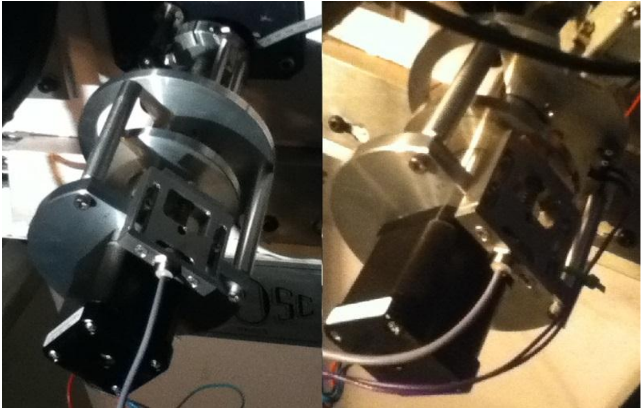
Figura 6. Fotos del mecanismo para controlar la apertura de la rejilla ensamblado sobre el instrumento cuando se realizaba pruebas.
