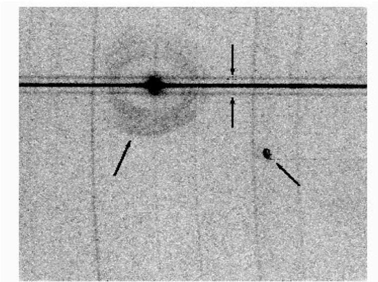
Figura 6 – Ejemplos de reflexiones espurias en fuentes brillantes.
