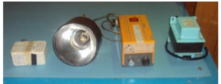
Figura 2: De izquierda a derecha: lámpara de Cadmio en su caja, reflector, fuente de alto voltaje, transformador.
