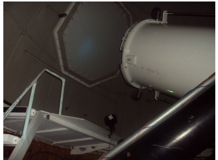
Figura 4: Reflector y telescopio apuntando a la pantalla de la cúpula.
