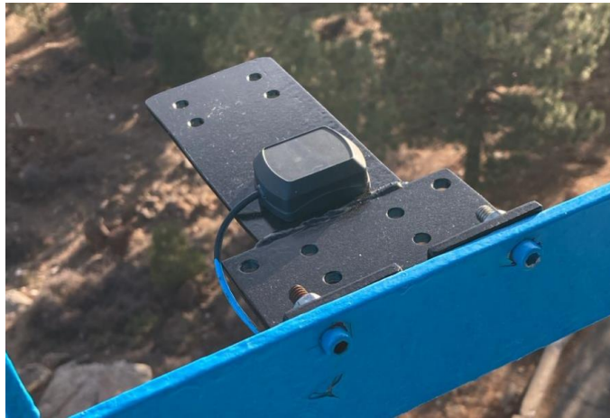
Figura 22: La antena del GPS es instalada de manera temporal sobre la baranda exterior
