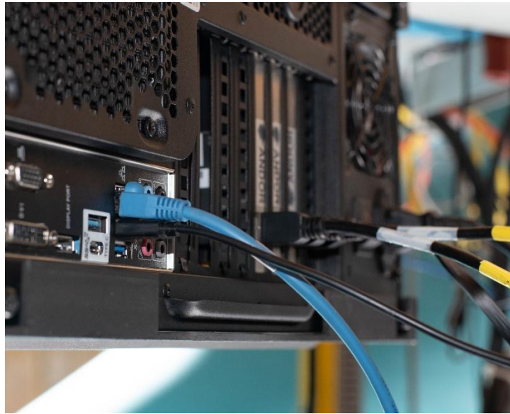
Figura 7. Conexiones de la computadora de control de OPTICAM, en la parte derecha se muestran las 3 conexiones USB particulares para las cámaras Andor.
