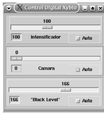
Figura II.3.- Ventana para el control de la cámara.
