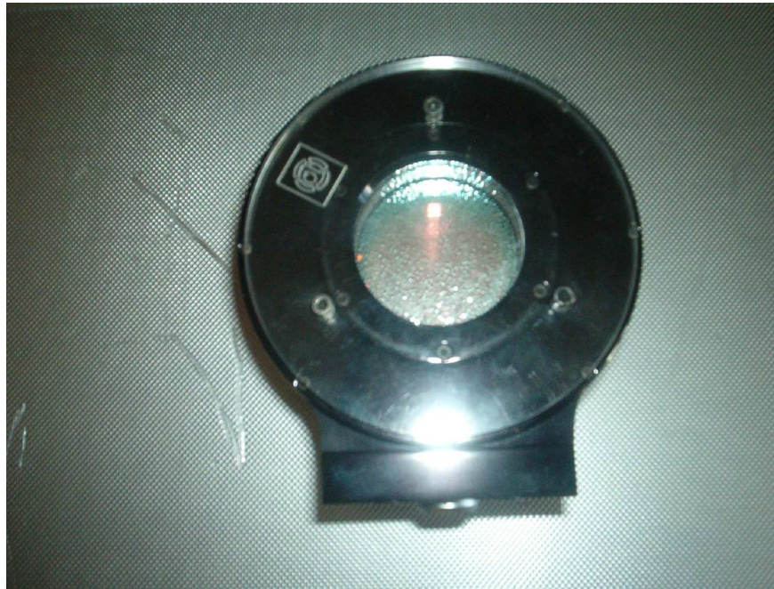
FIGURA 7.1: Fotografía del etalón Fabry Perot.
