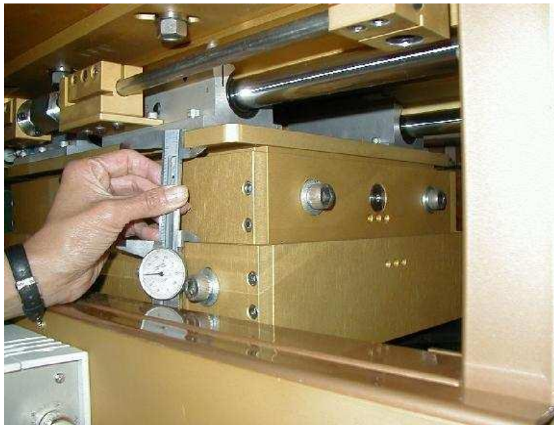
Figura 2.4: Midiendo inclinación en el punto NE.
