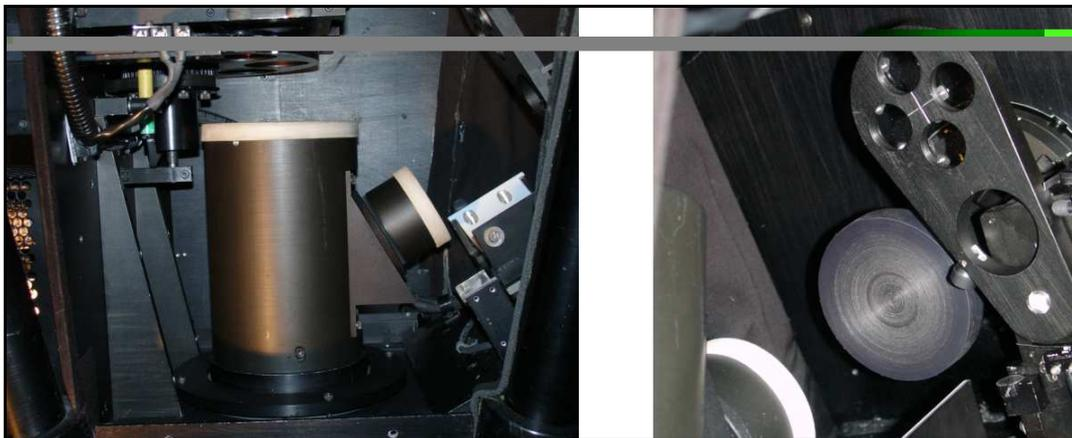
**Figura 6.** Cubiertas plásticas para los elementos ópticos, colimador (izquierda) y cámara (derecha).
