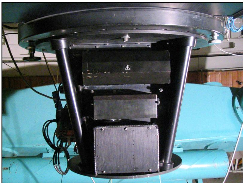
**Figura 30.** Tolva de protección de la rueda porta-filtros y la unidad de las lámparas de calibración .
