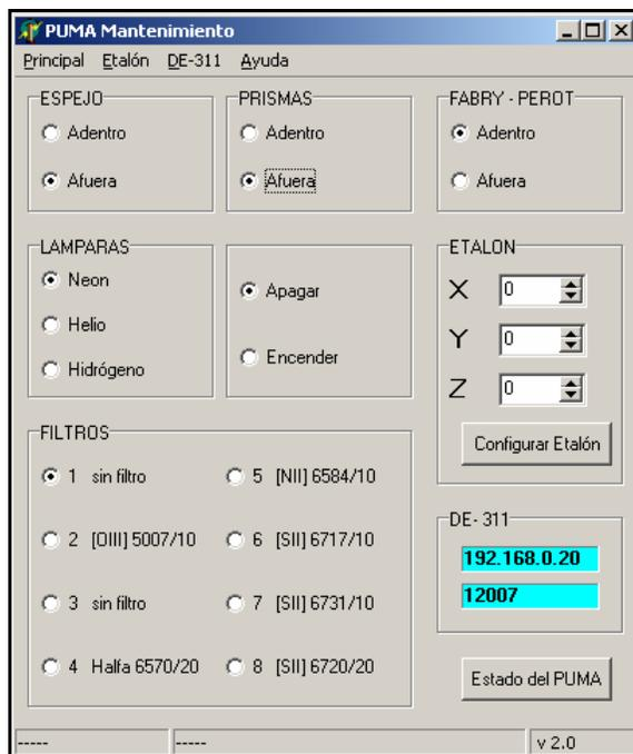
**Figura 26.** Ventana del programa MantoWin para verificar el funcionamiento del PUMA.
