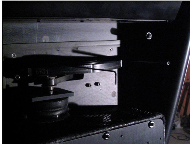
**Figura 32.** Perno de sujeción de los filtros.
