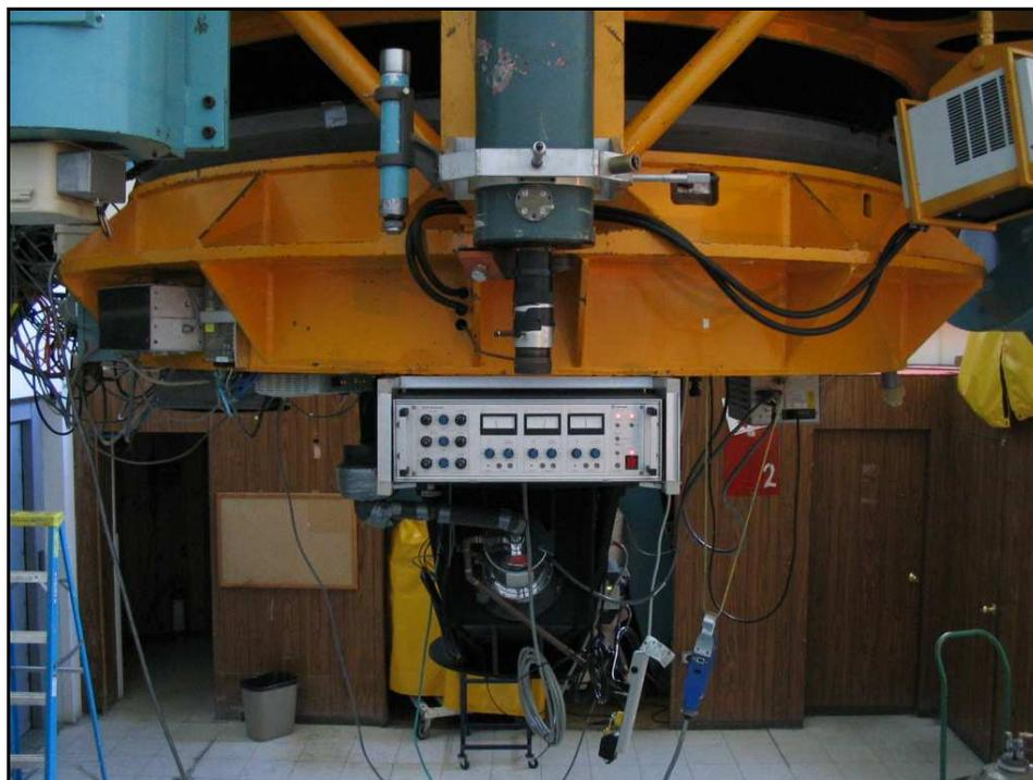
**Figura 4.** CS100 colocado en la celda del espejo primario del telescopio.
