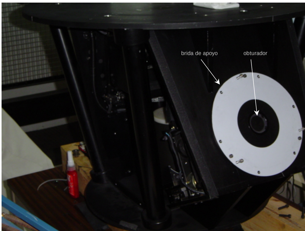
Figura 13: Ubicación de la brida de apoyo y, al centro, el obturador.
