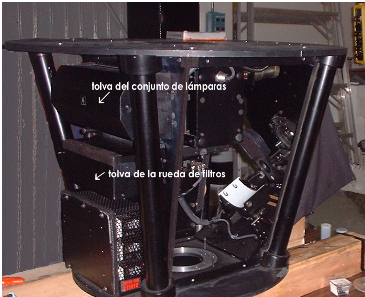
Figura 4: Ubicación de las tolvas del conjunto de lámparas y de la rueda de filtros.
