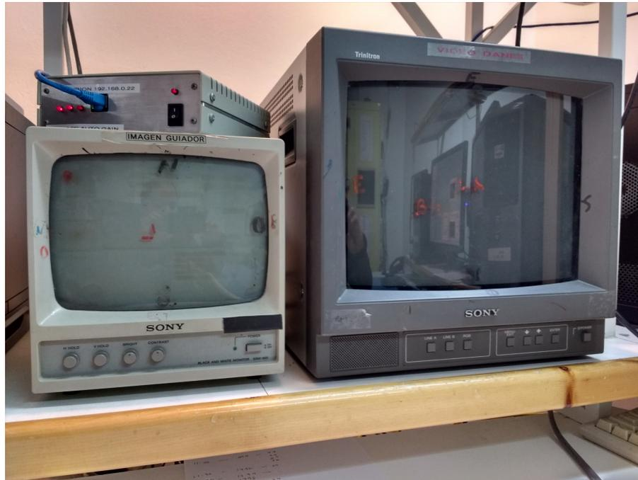
Figure 18: Monitores del guiador (izquierda) y buscador (derecha) en el Telescopio 84cm. Arriba del monitor del guiador se encuentra el potenciómetro del video del guiador.
