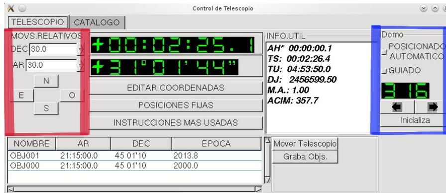
Figure 8: Interfaz del Control de Telescopio donde se indica la sección para offsets y direcciones al telescopio (recuadro rojo) y la sección del posicionado automático y guiado del domo (recuadro azul).
