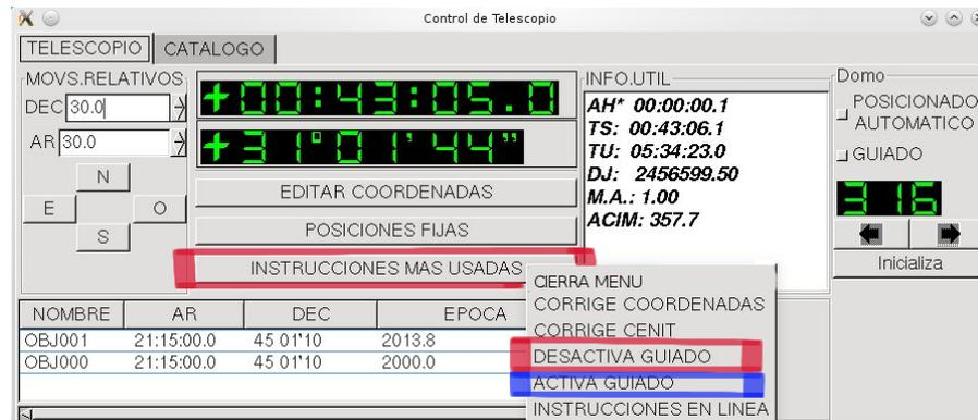
Figure 7: Interfaz de Control de Telescopio donde se indica cómo desactivar o activar el guiado de telescopio.
