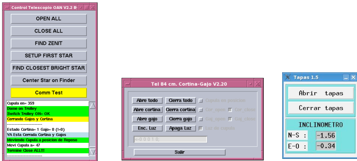
FIGURA 3. Izquierda: interfaz ‘control telescopio 2009’ igual en ambos telescopios. Centro: interfaz ‘cortina-gajo’ que opera solamente en el telescopio 0.84. Derecha: interfaz ‘Tapas 1.5’ que opera solamente en el telescopio de 1.5-m.
